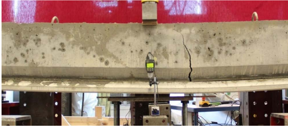
foto 16 Bezweken proefstuk met een lage betonsterkte
