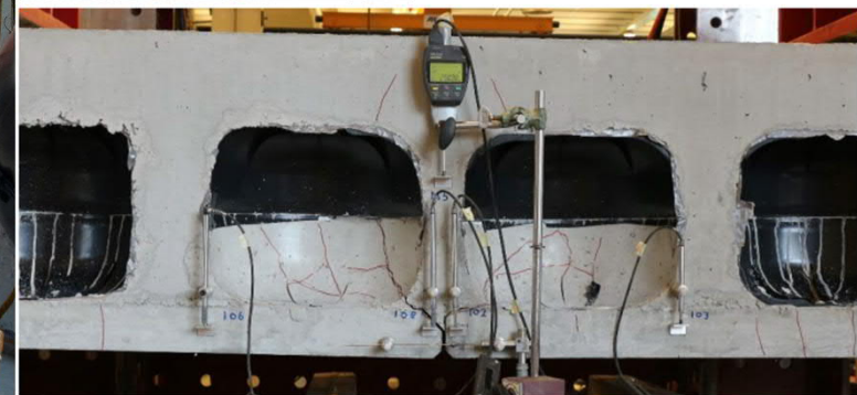
foto 4 Proefstuk BAM-Cobiax 1-2 bij een puntlast van 303 kN, forse scheidwijdte van scheuren nabij de voeg tussen de twee breedplaten
