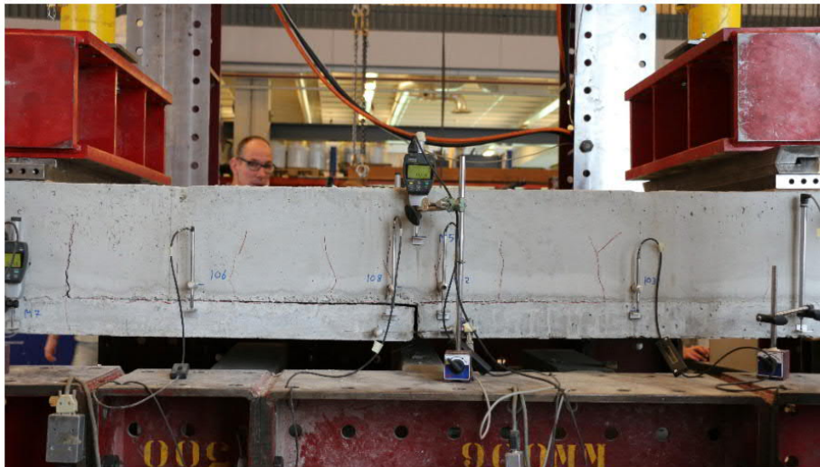
Foto 4. Proefstuk T01 is bezweken nadat de tralieligger uit de breedplaat is getrokken.
