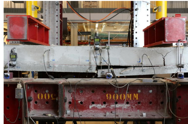
Foto 17. Het bezweken proefstuk T14 bij een vervorming van 28 mm.
